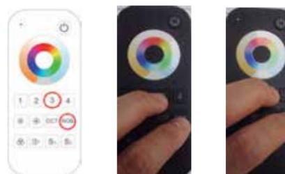
Después de realizar esta operación, la Zona 3 del mando, sólo controlará tiras LED RGB de forma que, se podrá regular la intensidad de brillo y el tipo de color (R/G/B) y, con la rueda de color, tendremos una regulación como se ve el centro de la misma que, además, coinciden con con las características siguientes:
