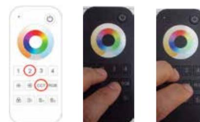
Después de realizar esta operación, la Zona 2 del mando, sólo controlará tiras LED blanco Tuneable-TW de forma que, se podrá regular la intensidad de brillo y la temperatura de color y, con la rueda de color, tendremos una regulación como se ve el los laterales de la misma que, además, coincide con con las características siguientes:
