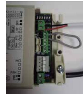
Imagen 4. Ejemplo conexión con driver 3030-33MmA
